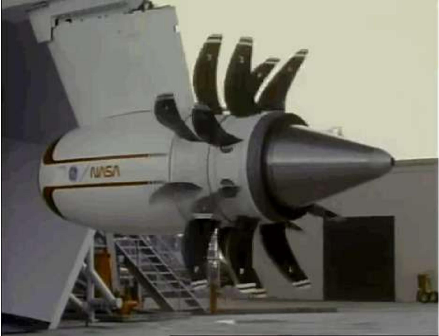
Экспериментальный авиационный двигатель GE36 Гибрид турбовентиляторного и турбовинтового двигателей.
