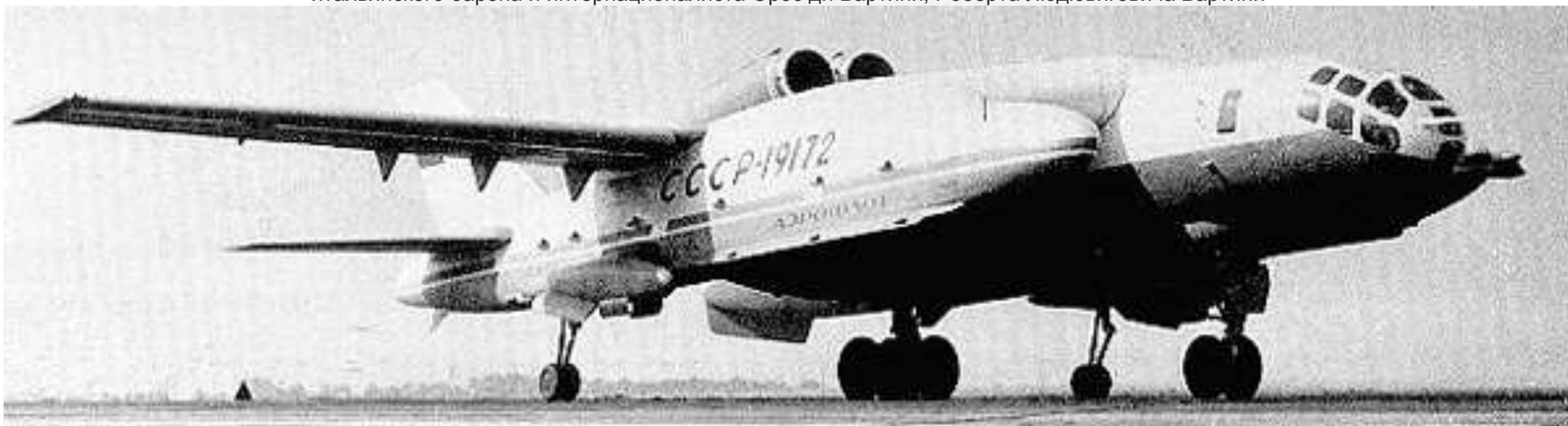
Это был самолёт - амфибия, который имел центроплан - летающие крыло размером с футбольное поле и массу 2500 тонн. Верхняя поверхность самолёта вполне могла бы служить палубой летающего авианосца. Концы центроплана оканчивались фюзеляжеобразными бортоотсеками, снизу которых крепились убираемые в полёте эластичные поплавки цилиндрической формы, а на кормовых частях киля и поплавки стабилизаторов.
